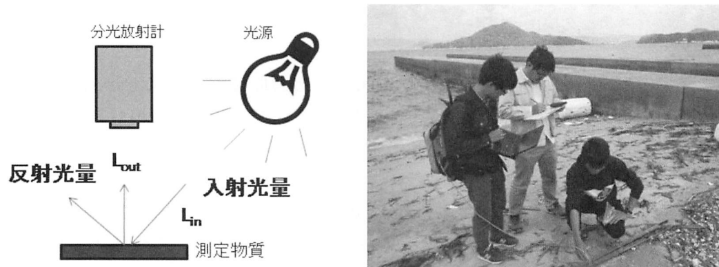
図-13 プラスチックの分光反射率測定の様式図（左）と海岸における実際の海ゴミの分光反射率計測の様子（右）
