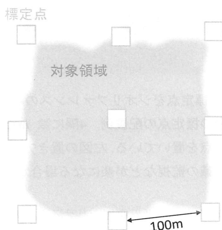
図- 9. 国土地理院のマニュアル案に基づく標定点の配置。対象領域が約200 m四方で、精度0.10 m以内を目指す場合、外周と内部の計9点必要。
