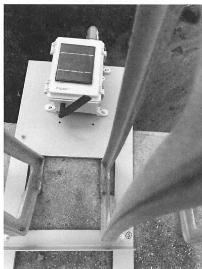
図-6 実際に樋井川の橋に設置された超音波センサー利用の河川水位センサーノードの例
