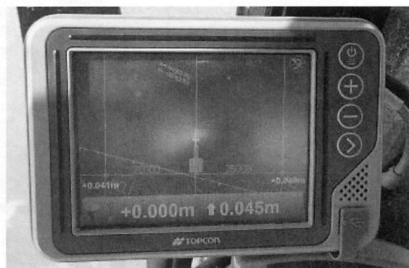
写真－4 運転席モニターで施工誤差を確認
