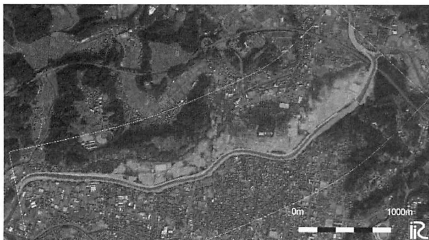
図-4.14 花月川夕田橋の閉塞による氾濫状況
