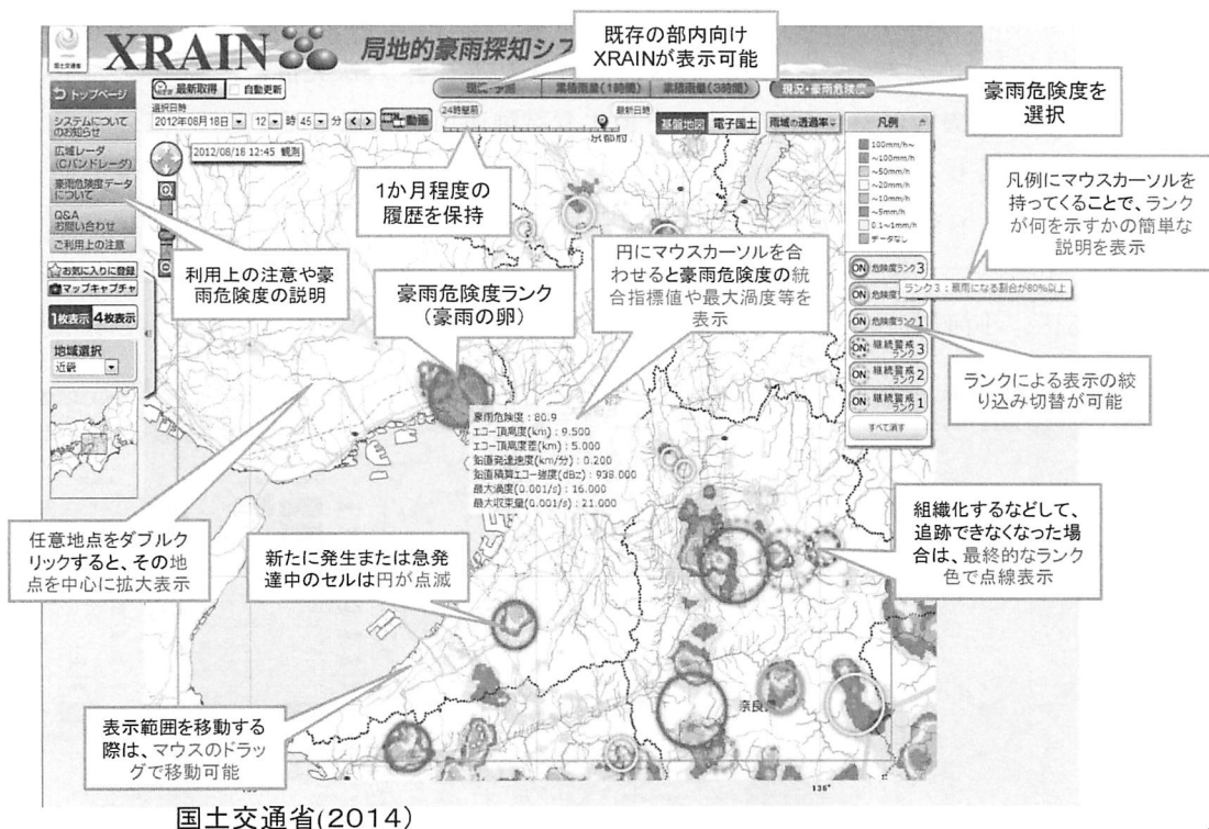
図7 国土交通省により試験運用されている局地的豪雨探知システム（ゲリラ豪雨の早期探知と鉛直渦度による危険性予測システム） 3), 9)
