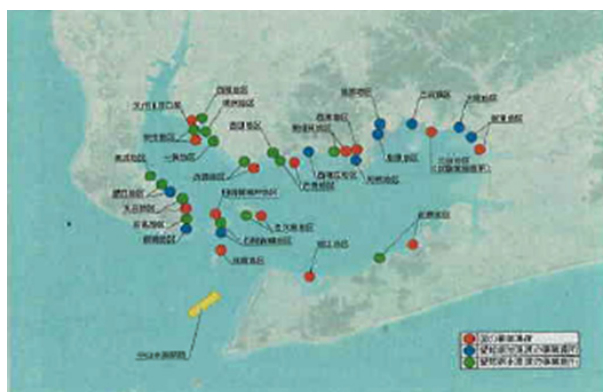
図-25 中山水道航路(図中黄色で示した箇所)の整備と浚渫砂を用いた干潟・浅場等の造成位置 (4)
