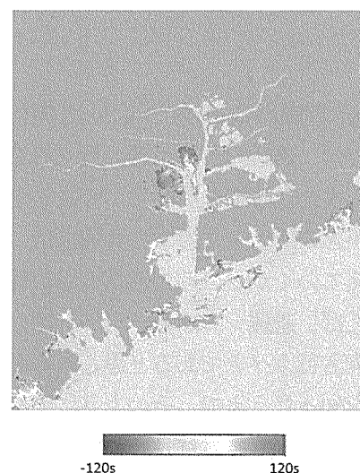
図-35 初期に全倒壊と半壊の場合の浸水開始時間の違い
