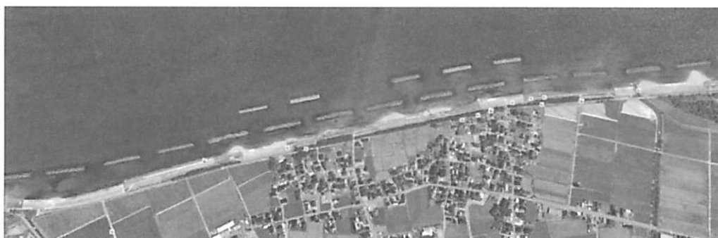
写真5 下新川海岸の離岸堤と副離岸堤群（海岸侵食が進行している）
