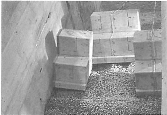
図-8 釜石港モデルのケーソンの倒壊の様子
