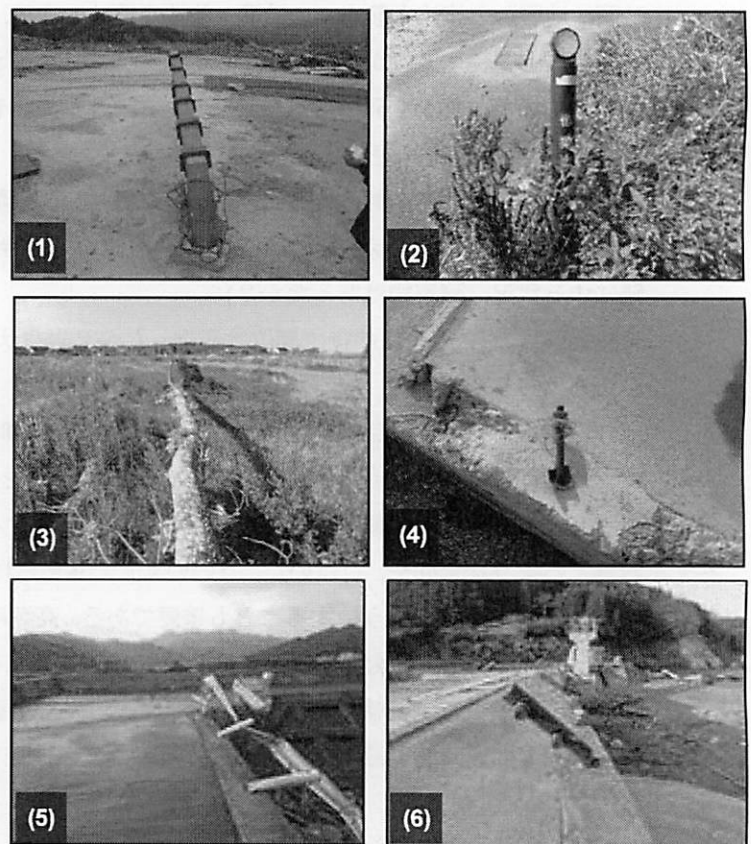
図-5 流跡調査対象とした柱状物の例(1)~(4)、および流向の判断が難しい柱状物の例(5)、(6)
