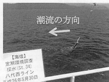
写真 3 湾口での調査状況 (潮流が速く多項目水質計が横に流れる)
