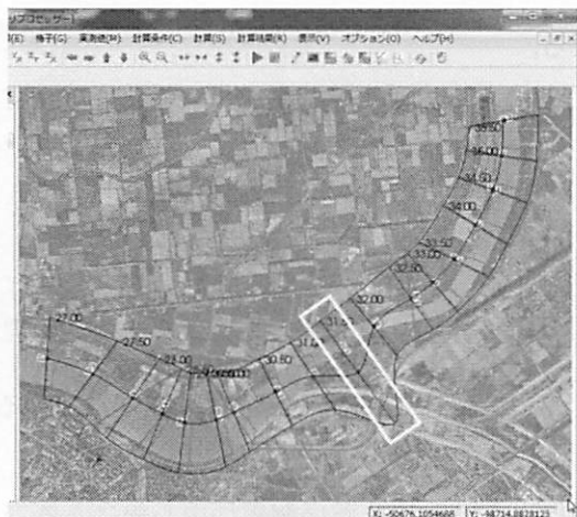
図—6 左岸に張り出した横断測線
