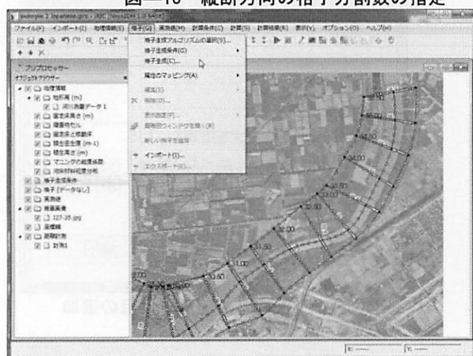
図—14 格子分割点の設定（黄色い点で表示）
