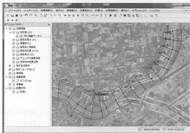
図—8 水路中心線と低水路中心線を合わせた状態
