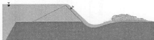
④崩壊が生じると堤防の安定性は極端に低下し破壊に至る。
