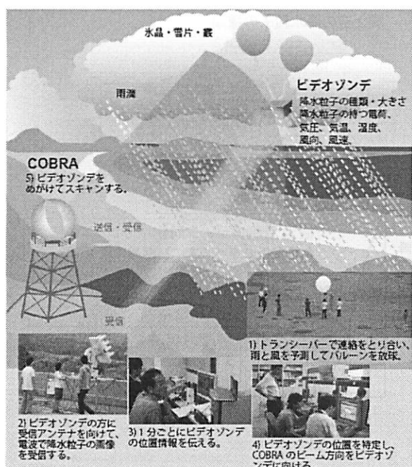
図 6 ビデオゾンデと最新型 5cm 波偏波レーダーとの同期観測
