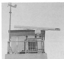
(b) アンテナ(長さ約 2.7 m)とHORS 研究施設への設置状況
