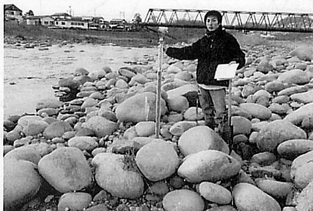
図-51(b) 出水後の中州低水路側の河床材料
