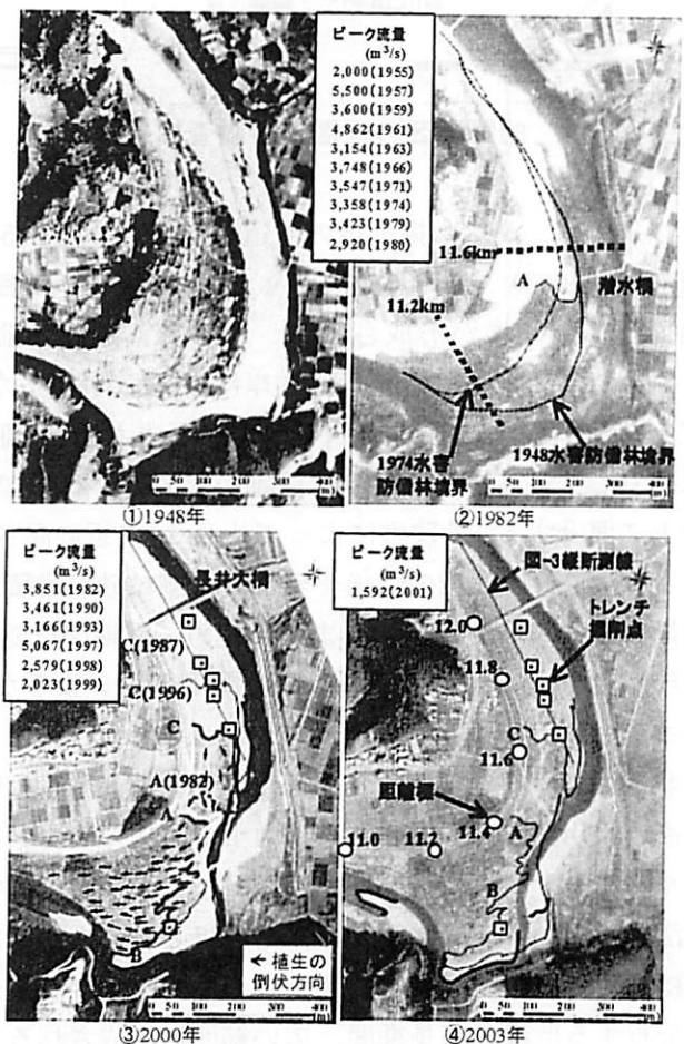
写真 3.3 本村地区の掘削後の変化
