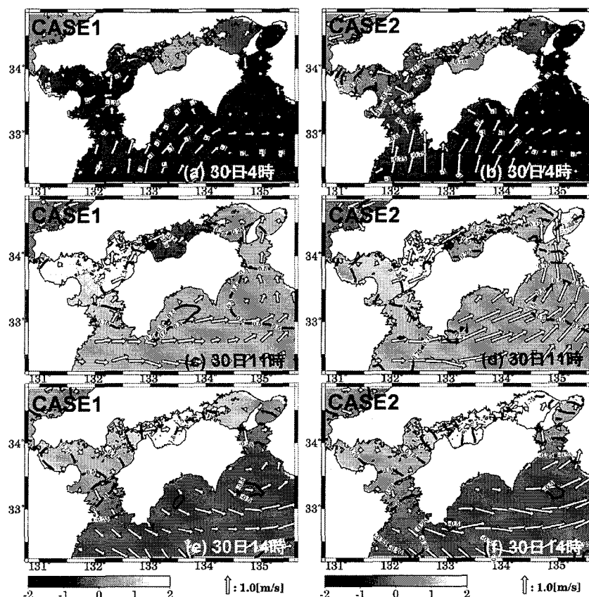
図-8 2 次元台風モデル (CASE1) 及びメソ気象モデル MM5 (CASE2) による風をそれぞれ用いた場合の表層流速と潮位の分布 14) 。
