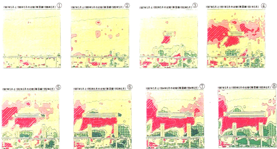
図-27 構造物の施工経過と周辺地形変化
