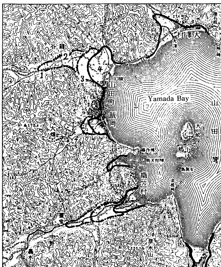
図－5 岩手県山田町の過去の津波浸水域。(—：昭和8年，――：明治29年， ····：慶長16年)(今村による)
