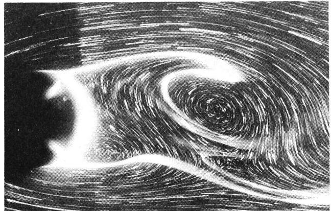
図9 円柱後流の統合流脈膜と流線の関係（電解沈澱法とアルミ粉法を同時使用） R=100
