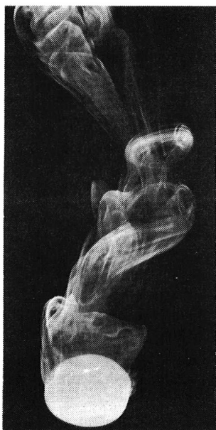
図15 水中を降下する油滴の統合流脈膜（色素液拡散法）油滴は四塩化チタン，色素はフルオレセイン， R=550
