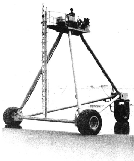
写真一七 CERCの海底測量車CRAB
