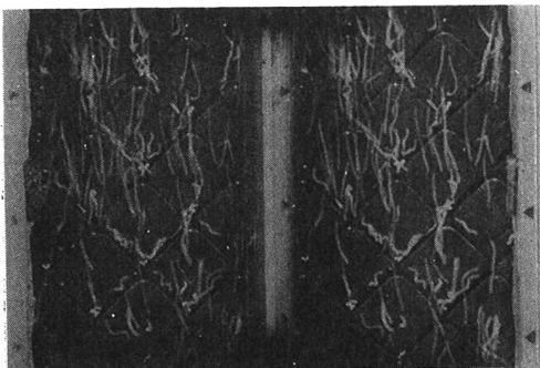
写真-20 水中トレーサーの1/2秒の軌跡の立体写真
