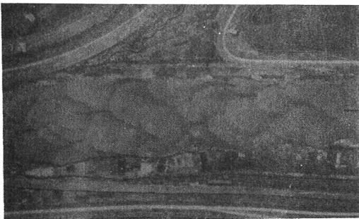
写真-1 笛吹川、水底のウロコ状砂州、 水流は複列蛇行
