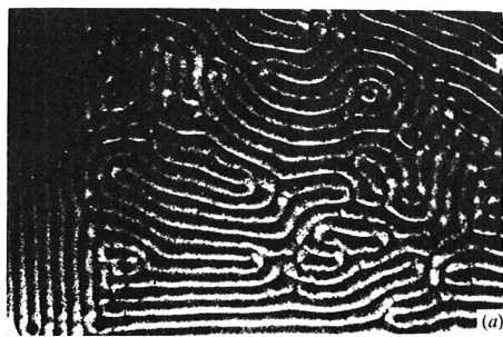
図-20 水平二平板間の対流（グラファイト粉法） Willisほか, J. Fluid Mech., 54 (1972) 351 より
