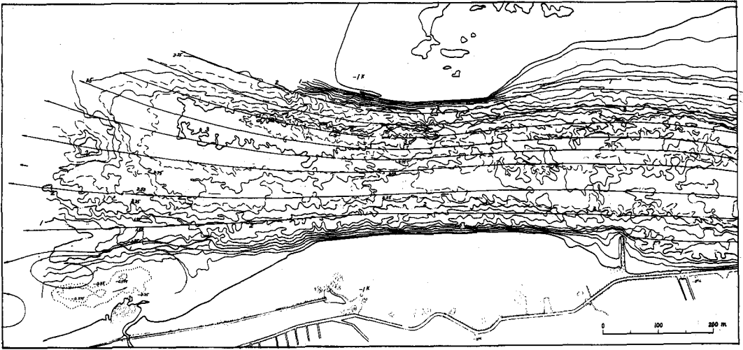
図 4.7 新北上川河口の流向と等流速線分布（北上川下流工事事務所）
