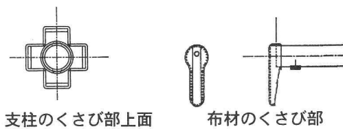
図-4 くさび結合部 D の形状
