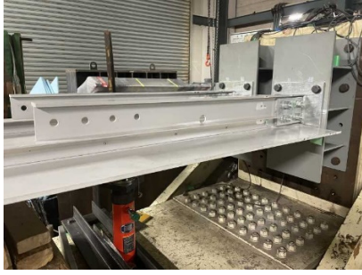
図-4 供試体設置状況（正側載荷）
