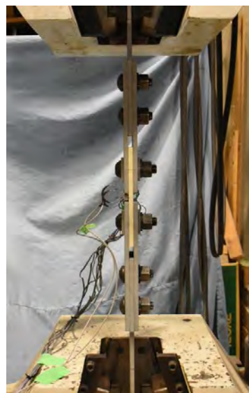
写真-3 摩擦接合継手の引張試験のセットアップ
