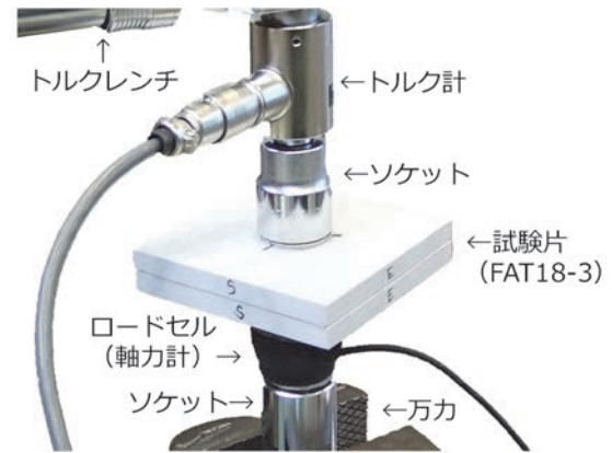
図-2 ボルトの締め付けの状況 (試験片: FAT18-3)
