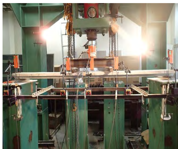
図-1 AFRP ロッドを適用したπ型断面 RC 梁の静的載荷試験
