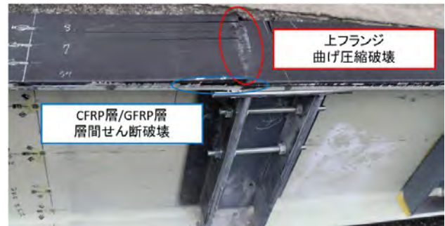
(b) HFRP 横桁 (4点曲げ载荷)
