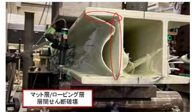
(d) GFRP 縦桁 (4点曲げ载荷)
