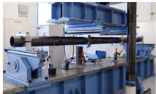
図-16 4点曲げ試験体の設置状況
