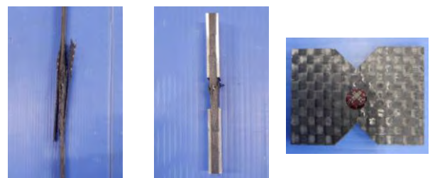
図-3 材料試験体の破壊形態
