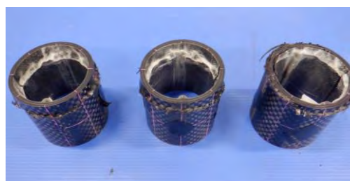
図-7 圧縮試験の破壊形態
