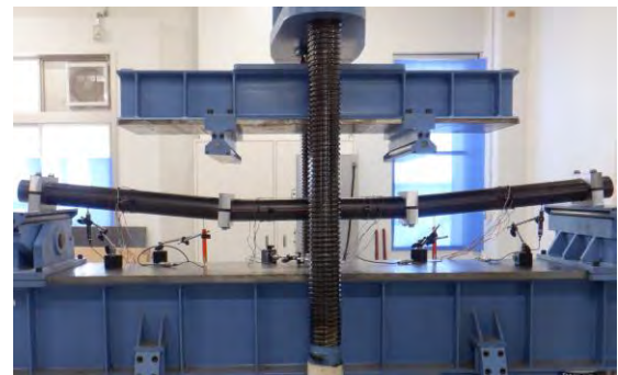
(a) 試験体全体
