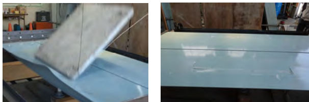
落下時 落下後 図-15 3GL-45H□-有-Cケースの落下時状況
