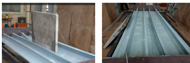
落下時 落下後 図-12 3GU-VrH□有-Cケースの落下状況
