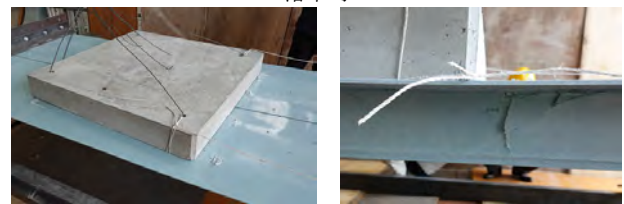
上面 側面 図-19 300kg-45度落下時状況
