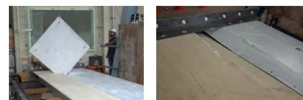
落下時 落下後 図-14 6FU-VrT◇無-Eケースの落下状況
