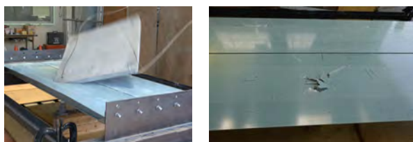
落下時 落下後 図-16 3GL-45H◇-有-Cケースの落下時状況
