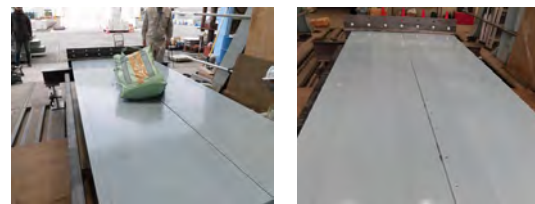
落下後 落下面 図-20 85kg砂袋落下時の状況
