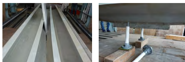
上面 下面 図-11 6GU-VrH□有-Cケースの落下状況
