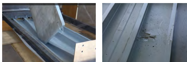
落下時 落下後 下面 図-13 3FU-VrB◇有-Cケースの落下状況
