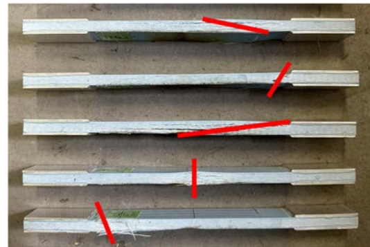
図-10 燃焼後の試験体の引張破壊位置
