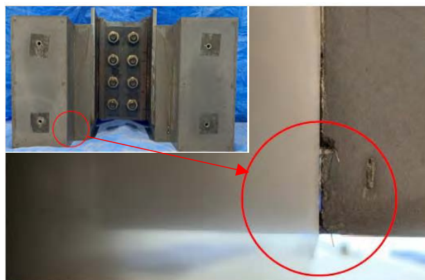
図-9 加熱後における間詰めと UFC 床版の接合部(A-2)
