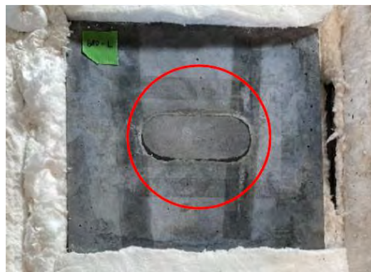
図-10 加熱後における箱抜き部で確認された自由水(A-3)
