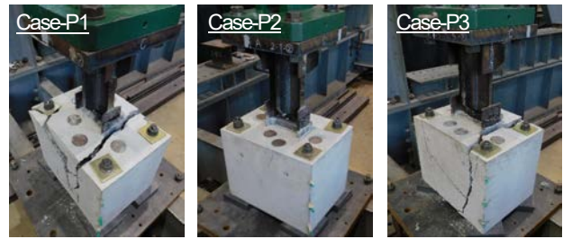
写真-3 試験体の損傷状況
