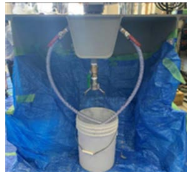
図-4 樹脂モルタルの充填状況
