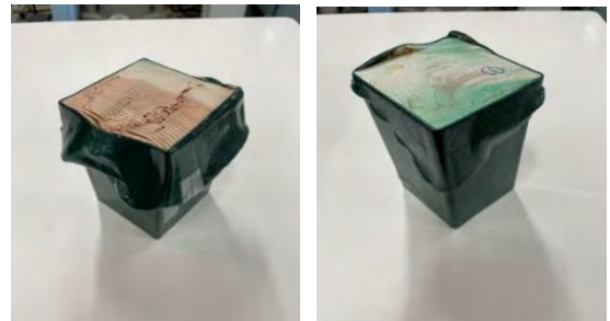
写真-8 ポリウレア全面塗装の破壊性状
