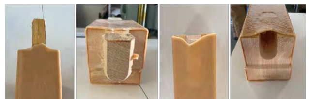
写真-7 機械加工の破壊状況(P-II-1)
