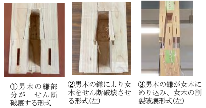
写真-5 破壊形式
