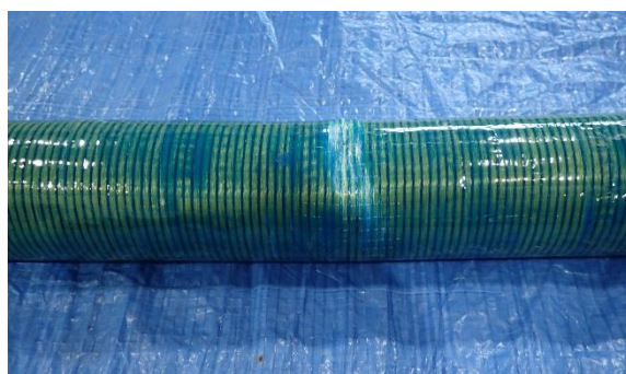
図-7 3点曲げ試験後状況
