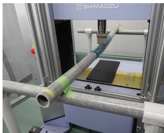
図-4 3点曲げ試験状況
