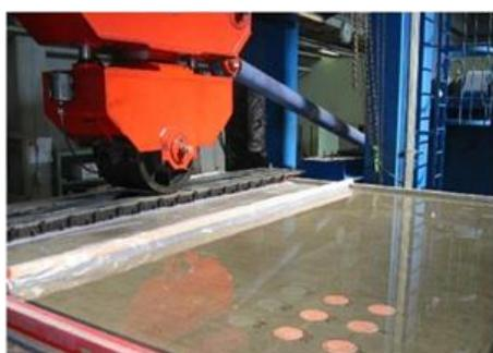
図-1 過年度の実大鋼床版試験体の輪荷重走行疲労試験状況<sup>2)</sup>
