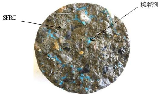
(a) 破壊面の例(50℃温水)
