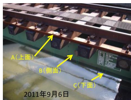
写真-5 外観調査用試験体の設置状況
