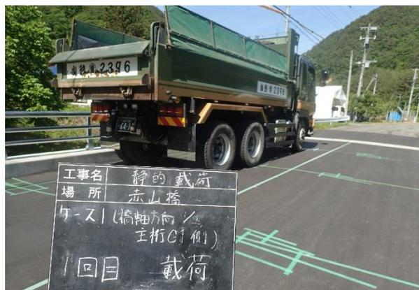
図3. 静的荷重試験実施状況
