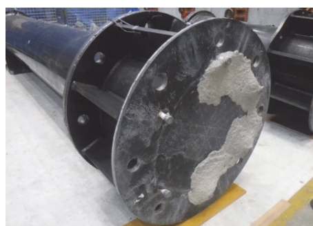
写真-2 曲げ供試体 鋼管ベースプレートの状況
