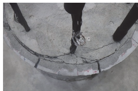
写真-3 曲げ供試体 荷重終了後の杭体南側上面の状況
