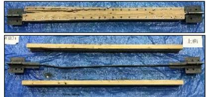
(c) 試験体WB31 (正面, 左側) : 板幅方向への破壊
