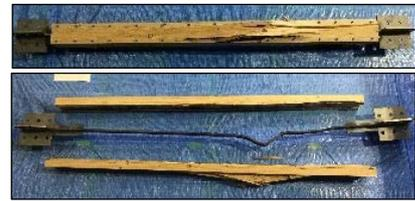
(a) 試験体WB11 (正面, 右側) : 局部破壊
