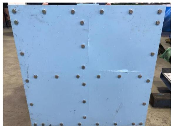
図-17 プレートガーダ形式FRP扉体 (FPG) の破壊形式
