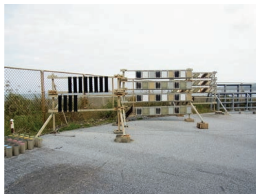
図-4 沖縄県大宜味村における暴露試験
