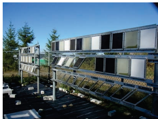
図-2 シェルブルック（カナダ）における暴露試験
