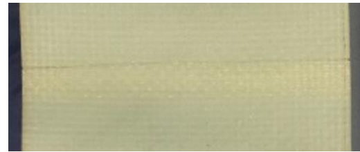
(c) スキンプレーットの圧縮破壊 (垂直材無し: 平面)
