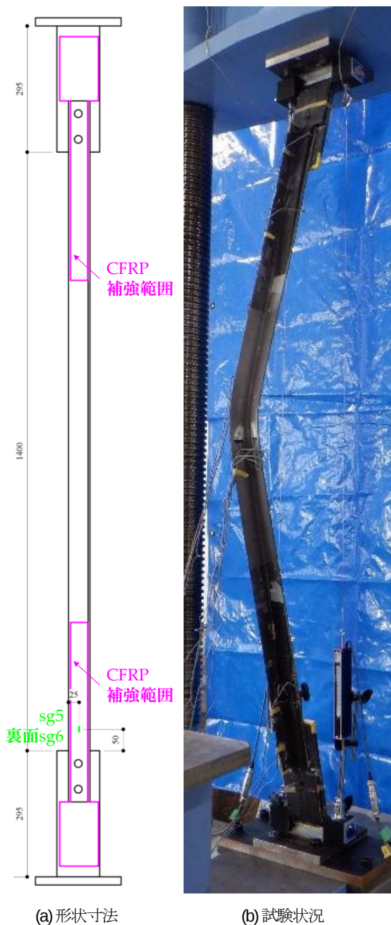
図-8 引張試験の寸法
