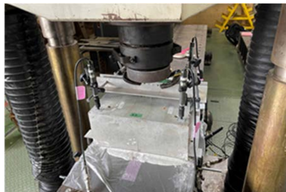
図-4 押抜き試験の状況
