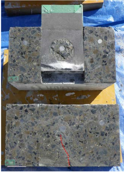
図-9 孔あきジベル界面の状況(A80)
